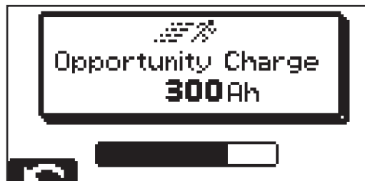
Displej na začátku mezinabíjení
