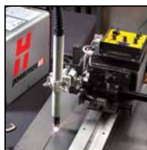
Kolejové řezání a drážkování
