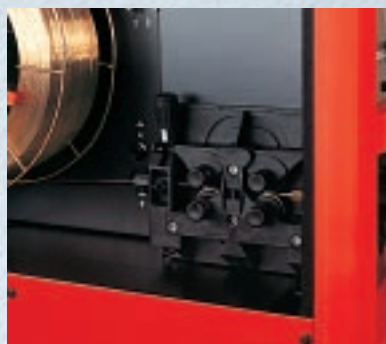
Bezproblémové podávání drátu zajišťuje 4-kladkový posuv
