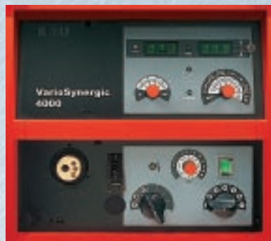
Jednoduchá obsluha: nastavení síly plechu a přídavného materiálu, pootočení knoflíkem – a je hotovo
