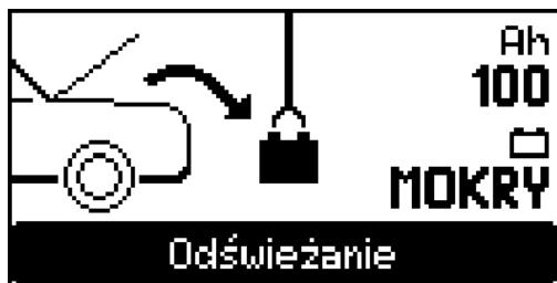
Tryb pracy Odświeżanie służy do reaktywacji głęboko rozładowanych lub zasiarczonych akumulatorów. Odświeżanie odbywa się po wymontowaniu akumulatora, na wolnym powietrzu lub w dobrze wentylowanych pomieszczeniach.
