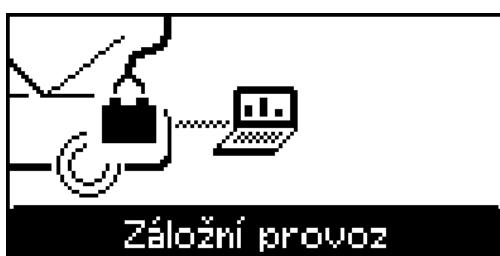
Vyrovnávací režim odlehčuje akumulátor vozidla během diagnostiky nebo aktualizace softwaru vozidla.
