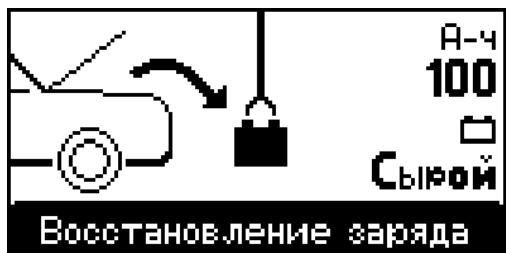
Режим работы «Восстановление заряда» предназначен для восстановления заряда глубоко разряженных или сульфатированных аккумуляторных батарей. Восстанавливющая зарядка применяется при извлеченной аккумуляторной батарее, на открытом воздухе или в хорошо вентилируемых помещениях.
