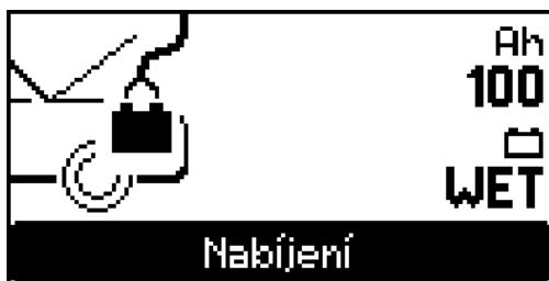
Nabíjecí přístroj se nachází v režimu napětí naprázdno - zobrazí se provozní režim nabíjení.
