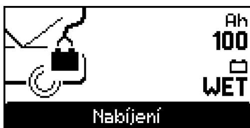
Provozní režim nabíjení je po připojení nabíjecího přístroje do sítě standardně k dispozici.
