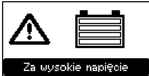
Zbyt wysokie napięcie akumulatora
