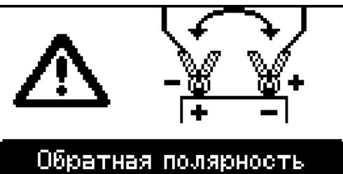
Неправильная полярность зарядных проводов, сработало приспособление для защиты от неправильной полярности
