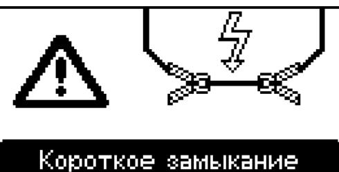
Короткое замыкание зарядных клемм или зарядного кабеля, функция распознавания короткого замыкания активна
