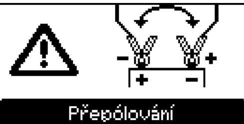
Přepólované nabíjecí vedení, reakce ochrany proti přepólování
