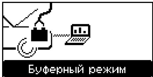
Буферный режим работы разгружает аккумуляторную батарею транспортного средства в процессе выполнения диагностики или обновления программного обеспечения.
