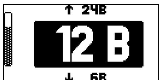
Примерно через 5 секунд зарядное устройство автоматически распознает напряжение аккумуляторной батареи, например 12 В, и начнет зарядку.
