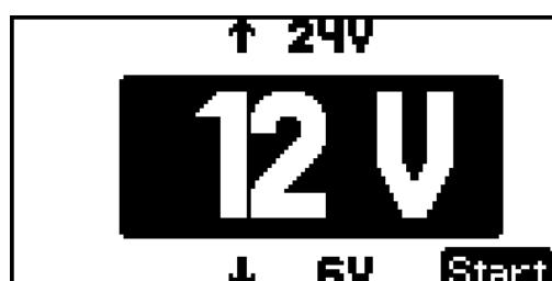
A töltőkészülék automatikusan felismeri a csatlakoztatott, pl. 12 V-os akkumuláltort és 5 mp után támogatja a jármű fedélzeti elektronikáját.
