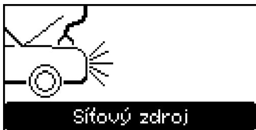
Provozní režim Síťový zdroj umožňuje napájení vozidla během oprav s vyjmutým akumulátorem.
