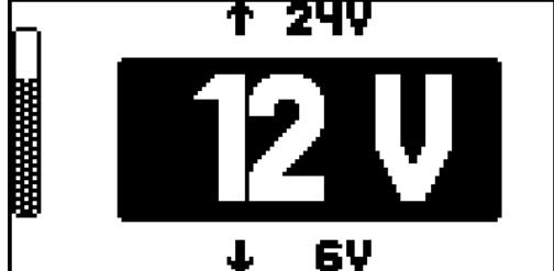
Laddaren identifierar det anslutna batteriet automatiskt, exempelvis 12 V och startar laddningen efter cirka 5 s.
