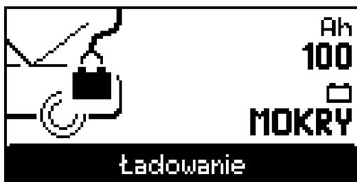
Tryb pracy „Ładowanie” jest dostępny po standardowym podłączeniu prostownika do sieci.
